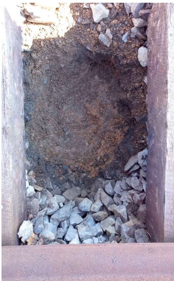
Obr. 2 a 3 Pohled na dno sondy v úrovni aktuální zemní pláň; Detail zemin tvořící stávající zemní pláň
