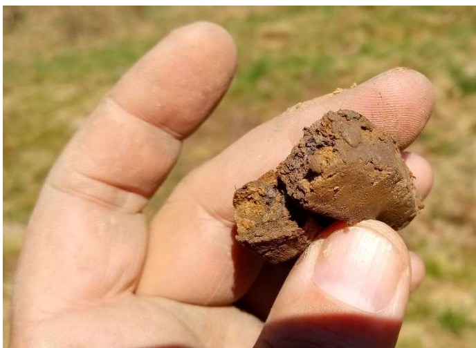
Obr. 6 Charakter hnědých jemně písčitých jílu tuhé/pevné konzistence
